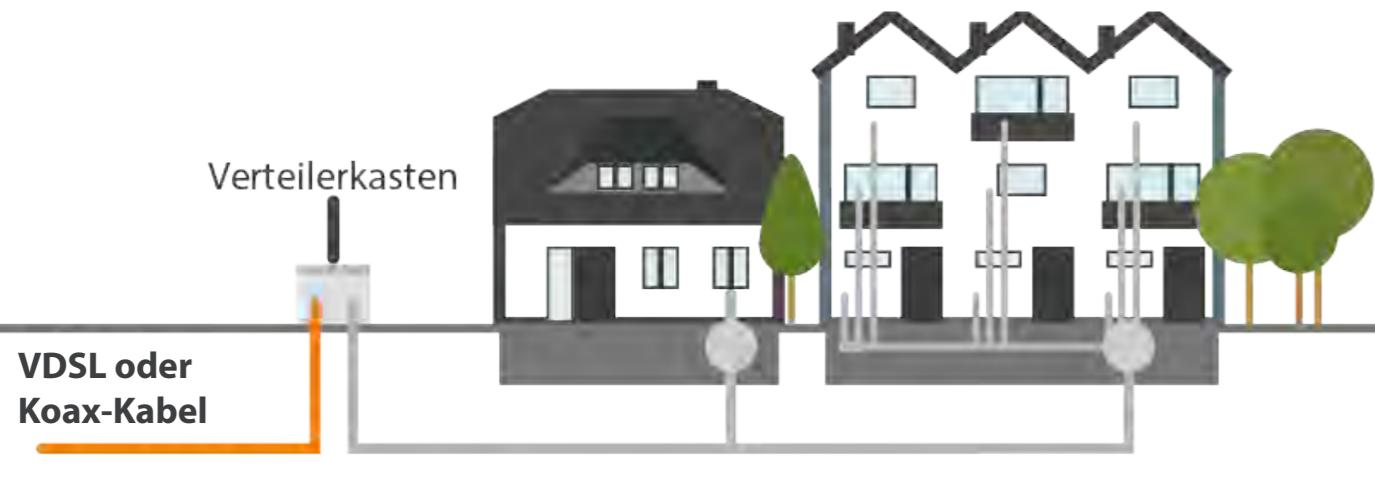
Glasfaser bis zum Verteilerkasten
