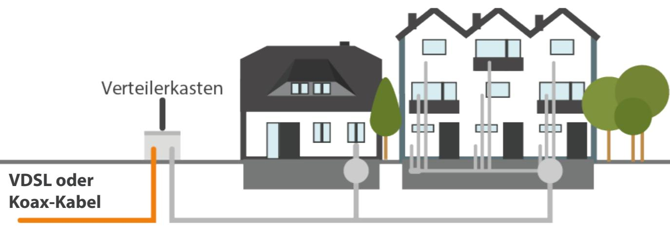
Glasfaser bis zum Verteilerkasten
